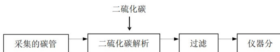
图 2-5 分析空气中的苯系物工艺流程及产污环节图
