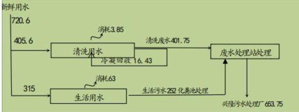
图 2.2-1 本项目水平衡图 (单位: t/a)
